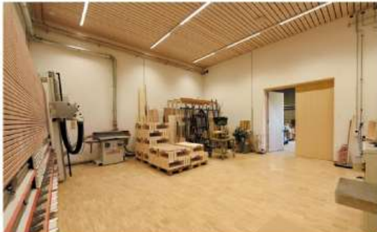
Nebst üblichem Maschinenpark weist die Schreinerei neu auch eine neue vertikale Plattensäge auf.
